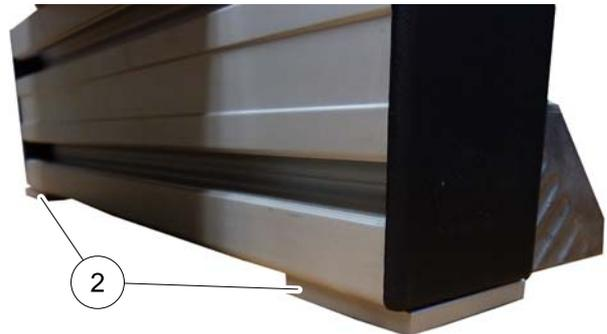
Per il montaggio, l'ampliamento è dotato di due perni di centraggio (3).
