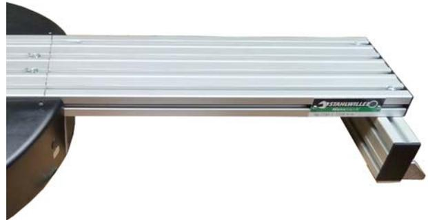
Per poter fissare l'ampliamento al piano di lavoro, dovete prima regolare le staffe di montaggio (5).
