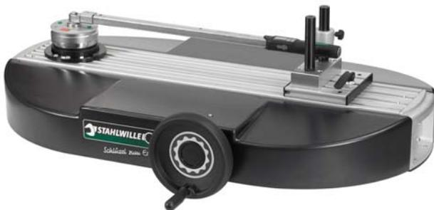
En el contorno del sensor de valores de medición hay un casquillo para una clavija de 3,5 mm. Aquí puede conectar un PC. Para ello utilice únicamente el cable jack de 3,5 mm y el adaptador USB de STAHLWILLE.
